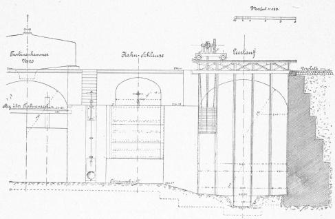
sperrung des Kanals durch einzulassende Dammbalken bei mittleren Wasserständen des Rheins zu ermöglichen (Fig. 11). Um jedoch den Kanal nicht zu sehr einzuengen, sind die Böcke in 5 m Entfernung von einander aufgestellt und so fest konstruiert, dass sie bei einem Wasserstande von 271 m
