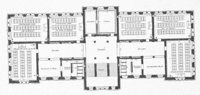
Grundriss vom Erdgeschoss. Masstab 1:500.
