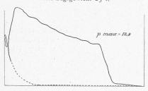
Anhalten mit Luftbremse auf  $24,3\,^{\circ}/_{0}$  Gefälle. Bremsweg = 5 bis 6 m.
