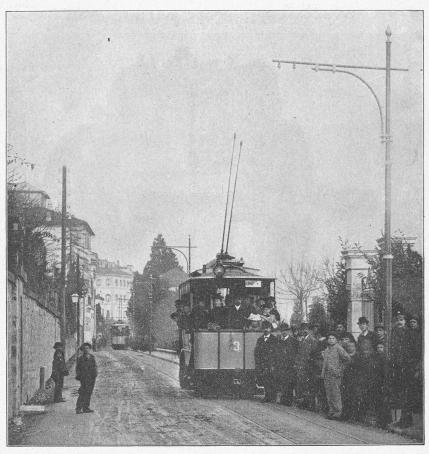
seitlich rechts und links um 12,5 cm und in der Längsrichtung um etwa 50 cm gegen das Wagenmittel versetzt sind. (siehe Fig. 5). Es verdient erwähnt zu werden, dass die Verwendung zweier Trolleys dank der exakten Montierung der Kontraktdrähte im Betrieb praktisch keine Schwierigkeiten verursacht, wie dies anfanglich befürchtet wurde.
