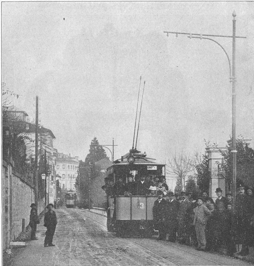
Fig. 5. Strassenbahn in Lugano. Wagen mit den beiden Trolley-Armen.
