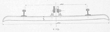
ein A, damit ist die Gesamterweiterung auf 12 mm gestiegen, wovon 4 mm auf die äussere, 8 mm auf die innere Schiene entfallen. (In Fig. 14 ist nur Plättchen B dargestellt.)
