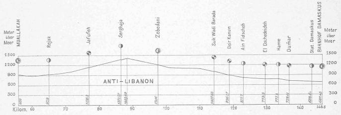
Fig. 6b. Längenprofil von Muallakah nach Damaskus.
