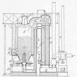
Fig. 1. Röhrenüberhitzer am Taylor'schen Gaserzeuger.
