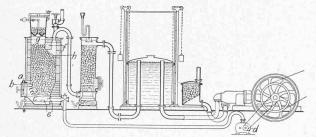
Fig. 2. Gaserzeuger von Buire-Lencauchez.
