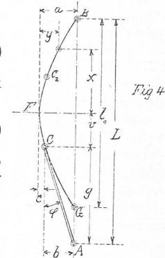
Hiebei ist  $P = \text{Kraft}$ , die den zu berechnenden einen Balken beansprucht,  $f$  dessen Querschnitt und  $k$  dessen Trägheitsradius.
