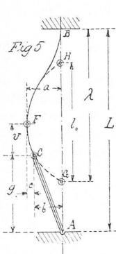
Der in Fig. 5 dargestellte Fall, wo das Ende des geradlinigen Teiles frei drehbar befestigt, das andere Balkenende festgeklemmt ist, lässt sich in ähnlicher Weise erledigen. Der Spannungszustand in dem am stärksten beanspruchten, weil am stärksten gekrümmten Teil  $CF$  stimmt überein mit demjenigen des Stückes  $CF$  des Stabes  $GCFH$ . Von letzterem Stabe ist bekannt, dass
