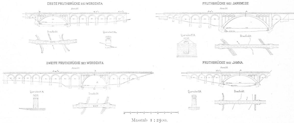
Die Ausführung der grössern Gewölbe ist, um die Belastung der Lehrgerüste und bezügliche Senkungen zu verhindern, vorerst trocken und ringweise vorgenommen worden; hiebei wurden in die Fugen Holzleisten eingelegt und erst nachträglich wurde der Mörtel mittelst Flachschienen in dieselben eingebbracht.
