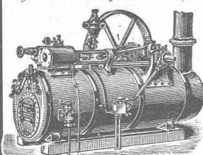
ferner transportable Dampfmaschinen mit stehendem geschweissen Querrohrkessel
