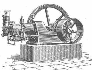
Petroleum-Motoren stehender und liegender Konstruktion bis 25 Pferdekräfte.
