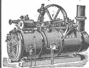
ferner transportable Dampfmaschinen mit stehendem geschweißten Querrohrkessel
