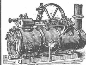
ferner transportable Dampfmaschinen mit stehendem geschweißten Querrohrkessel
