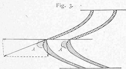
schlimmer, je dicker die Schaufeln sind. Es ist daher durchaus verkehrt, wenn man bei Jonvalturbinen durch eine übermässige Verdickung der Radschaufeln am oberen Ende (siehe Fig. 3) das richtige Verhältnis der Kanalquerschnitte erzwingen will. Was man auf diesem Punkte gewinnt, geht durch den Stoss auf den Schaufelrücken reichlich wieder verloren.
