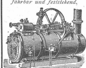
ferner transportable Dampfmaschinen mit stehendem geschwungenem Querrohrkessel bauen als Spezialität und halten auf Lager
