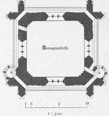
Schwarz ausgezogener und angelegter Grundriss bei II im Turm - Vertikalschnitt. — Punktierter Grundriss bei I im Turm-Vertikalschnitt.
