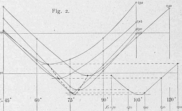
Aus den beiden Hülfskurven folgt nun, dass man, um unter den anfangs angegebenen Bedingungen einen möglichst ruhigen Gang der Maschine zu erhalten, den kleinen Cylinder zu  $z = 0,386$  des grossen nehmen und die Niederdruckkurbel der Hochdruckkurbel um  $\alpha = 77^\circ$  oder  $180^\circ + 77^\circ$  nachreihen muss. Dadurch sinkt das Flächenverhältnis auf 0,0235.
