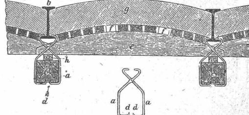
Diese Halter haben den grossen Vorteil, dass neben der bedeutenden Zeitsparnis beim Aufbau des Gerüstes die seither nötigen Hölzer zum Absteifen ganz fortfallen. Der Aufbau eines Gerüstes nach früherer Methode bedingt ungefähr so viel Zeit, wie das Rüsten und Mauern einer Gewölbekappe bei Anwendung dieser Halter.
