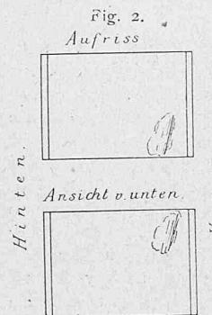
Die erwähnte Beschädigung des Dampfcylinders ist durch nebenstehende Fig. 2 dargestellt. Sie besteht in einer starken, etwa über ein Viertel des Umfanges sich erstreckenden Quetschung und lässt sich nur dadurch erklären, dass der Dampfcylinder, nachdem sich die Lokomotive um etwa  $45^{\circ}$  um ihre Längsachse gedreht hatte, auf die Mauerkante des Widerlagers aufgeschlagen hat. Die Quetschung enthält eine deutliche Furche, deren Richtung genau mit derjenigen des Widerlagers übereinstimmt.
