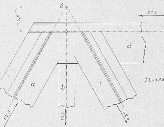
befinde sich am letzten Hängeisen), so entstehen in den vier Stäben die in der Tabelle (sowie in beistehender Fig. 1) eingeschriebenen Kräfte und Spannungen.
