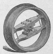
Fig. 2. Riemenscheibe mit einer Flantsche.
