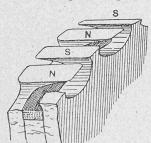
ganz vorzügliche Ausnutzung des magnetischen Feldes gestatten, wodurch sowohl die zur Bewickelung erforderliche Kupfermenge, als auch der Erregerstrom auf ein Minimum reducirt werden. Die Erregung geschah durch eine von der Allgemeinen Electricitätsgesellschaft hergestellte Gleichstrommaschine N. G. 50, welche durch eine besondere Turbine angetrieben wurde.
