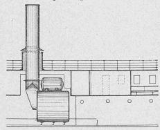
Fig. 1. Schnitt durch den Maschinenraum und Ansicht des Kessels. Masstab I: 200.
