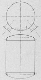
Fig. 3 u. 4. Vertical- und Horizontalschnitt durch den Vertical- und explodirten Dampfsammler. Masstab 1:50.
