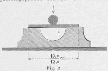
schah nach Anleitung von Fig. 2 mit thunlichster Sorgfalt unter einem Dampfhammer. Hiebei konnte die Längsprobe rissfrei gänzlich gefaltet werden. Die Querprobe brach, bevor eine nennens-
