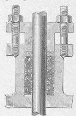
Nach den bis heute vorliegenden Erfahrungen sollen sich diese Metall-Stopfbüchsen bewährt und selbst sehr hohem Dampfdruck widerstanden haben. Als weitere Vortheile werden geltend gemacht, dass die Kolbenstangen nicht rosten und dass Staub, Sand, der etwa an den Kolbenstangen hängen bleibt, sich zwischen die Vertiefungen der Riffelungen versenken kann, wesshalb sich diese Packung besonders für Locomotiven eignen soll.
