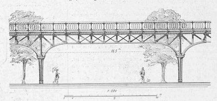
Die Anordnung der Hauptträger bei den Haltestellen ist derjenigen in der freien Strecke entsprechend. Es kommen also auch bei den Haltestellen nur zwei Hauptträger zur Anwendung; jedoch mit dem Unterschiede, dass dieselben in 6,0 m Abstand von einander liegen; also nicht unter den Geleisen, wie auf der freien Strecke, sondern ausserhalb der Geleise neben den letzteren. Die Bahnsteige und die Wände der Halle sind dann auf seitlichen Auskragungen dieser Hauptträger aufgebaut.
