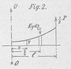
1) für x = 0 ist  $\frac{dy}{dx} = 0$ , 2) für -x wird y eben so gross als für +x, 3) für x = l wird  $\frac{d^2y}{dx^2} = 0$ , 4) muss  $\int_0^1 Ky dx$  $= \frac{1}{2} P \text{ sein.}$
