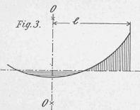
Druck mehr auf den Balken. Wählt man die Bolzenlänge grösser als 6,6 d, so wird yo negativ, d. h. in der Mitte drückt der Bolzen auf das Holz in entgegengesetzter Richtung als an den Enden.
