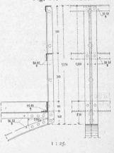
trägers unabhängig von der Lage der Zorèseisen durchgeführt werden und endlich wird dadurch die principiell geforderte und durchgeführte räumliche Trennung der Haupt-Tragconstruction von den Fahrbahntheilen erreicht, sodass eine allfällige Abnützung nur die Füsse der Zorèseisen und die Leiste, nicht aber den Querträger treffen kann.
