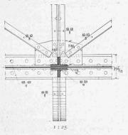
Fig. 15. Horizontalschnitt am Auflager.
