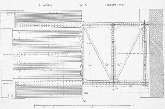
Fig. 6. Horizontalabschnitt am Knotenpunkt c.
