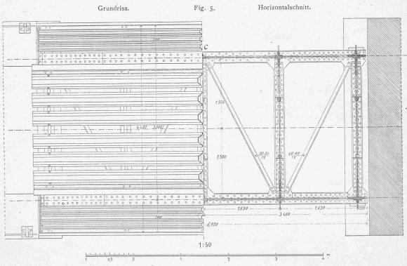
Fig. 6. Horizontalabschnitt am Knotenpunkt c.
