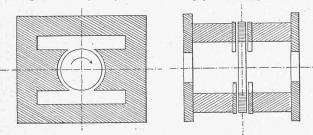
der offenen Form entsprechend eine vorzügliche. Dagegen bildet die hohe Lagerung der Armatur, welche eine sichere Fundirung erschwert und deshalb leicht zu störenden Vibrationen Veranlassung gibt, einen Nachtheil dieser Construction; ferner tritt bei dieser magnetischen Disposition häufig eine unsymmetrische Anordnung des Kraftfeldes auf, welche u. A. wiederum eine starke Vermehrung des Lagerdruckes zur Folge haben kann.
