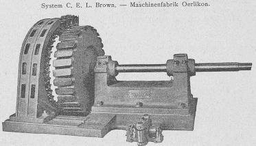
Drei-Phasen-Wechselstrom-Maschine von 300 P. S.
