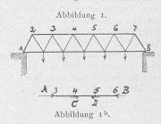
dass die Berechnung in der gewöhnlichen Weise erfolgt sei und dass der Obergurt etwa einen T-förmigen Querschnitt erhalten habe, der genügend steif ist, um ein Ausknicken der einzelnen Stäbe nach allen Seiten zu verhüten. Ich stelle nun die Frage, ob dieser Balken, wenn er für sich allein aufgestellt und vor allen wagrechten Belastungen geschützt ist, thatsächlich stabil ist und beantworte sie sofort mit "Nein".
