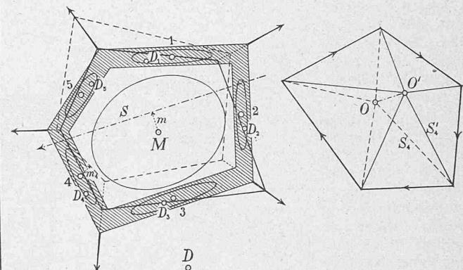
haben die beiden Polygone bekanntlich eine gerade Linie als Collineationsachse gemein, das heisst je zwei entsprechende Seilpolygonseiten schneiden sich auf ein und derselben Geraden, und diese Gerade läuft parallel zur Verbindungsline beider Pole.
