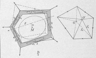
haben die beiden Polygone bekanntlich eine gerade Linie als Collineationsachse gemein, das heisst je zwei entsprechende Seilpolygonseiten schneiden sich auf ein und derselben Geraden, und diese Gerade läuft parallel zur Verbindungslinie beider Pole.
