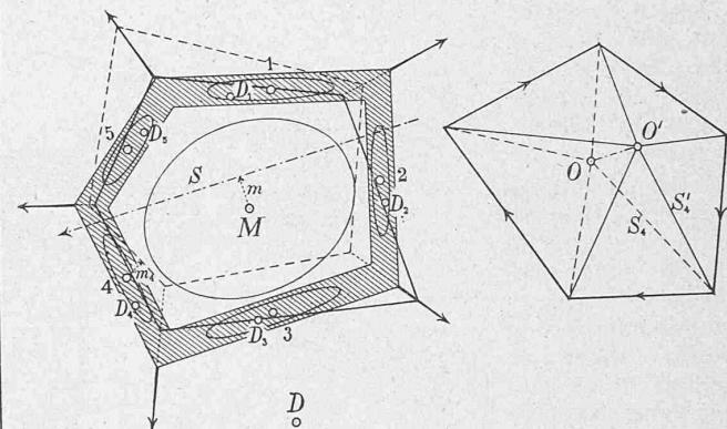
haben die beiden Polygone bekanntlich eine gerade Linie als Collinearachsen gemein, das heißt je zwei entsprechende Seilpolygonseiten schneiden sich auf ein und derselben Geraden, und diese Gerade läuft parallel zur Verbindungsline beider Pole.
