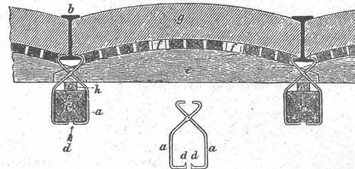
Diese Halter haben den grossen Vortheil, dass neben der bedeutenden Zeitsparnis beim Aufbau des Gerüstes die seither nötigen Hölzer zum Absteifen ganz fortfallen. Der Aufbau eines Gerüstes nach früherer Methode bedingt ungefähr so viel Zeit, wie das Rüsten und Mauern einer Gewölbekappe bei Anwendung dieser Halter.
