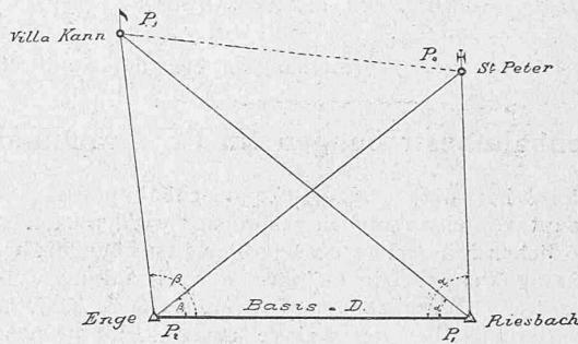
Am 3. Februar wurden die Winkel  $\alpha$ ,  $\alpha_1$ ,  $\beta$  und  $\beta_1$  in den Punkten  $P_1$  und  $P_2$  je 5 mal in beiden Lagen des Fernrohrs durch Repetition gemessen und hiebei gefunden:
