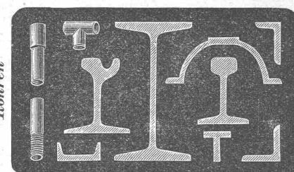
Eisenbahn- und Strassenbahnschienen. Complete
