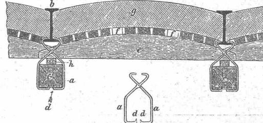
Diese Halter haben den grossen Vortheil, dass neben der bedeutenden Zeiter sparniss beim Aufbau des Gerüstes die seither nöthigen Hölzer zum Absteifen ganz fortfallen. Der Aufbau eines Gerüstes nach früherer Methode bedingt ungefähr so viel Zeit, wie das Rüsten und Mauern einer Gewölbekappe bei Anwendung dieser Halter.
