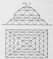
durchgeführt werden, wie ich es oben angab. Ohne Aenderung der Stabführung eignet sich das System zur Ueberdeckung von Räumen bis zu etwa 60 m Seitenlänge. Es kann aber ohne Schwierigkeit auch für noch grössere Längen eingerichtet werden, wenn nur das Verhältniss zwischen Schmalseite und Langseite nicht zu ungünstig wird.
