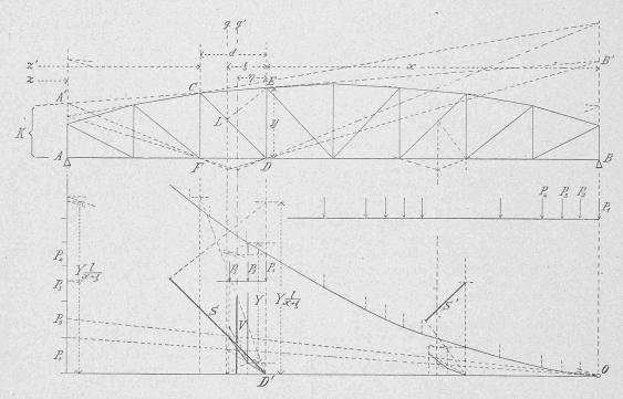
gefunden wird. Durch Zerlegung von Y' nach den Richtungen von CD, CE und DF ergibt sich die Spannung S. Da die Kraft Y' durch den Endpunkt C der Strebe geht, so wird die in DF wirkende Componente gleich Null. Man findet also, wenn DE = v und CD = v gesetzt wird
