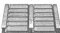
Vorteilhaft als Ersatz für Beton- und Backsteingewölbe zwischen I-Eisen.
