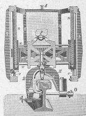
des Tasters um die senkrechte Achse S um  $180^{\circ}$  möglich. Der innere Schieber trägt ferner an seinem oberen Ende bei p einen Bleistift, der mittelst einer beim Nichtgebrauch hemmbaren Feder, gegen ein auf einer verticalen Tafel befestigtes Blatt Papier drückt und das dem aufzunehmenden Profil congruente Profil zeichnet.
