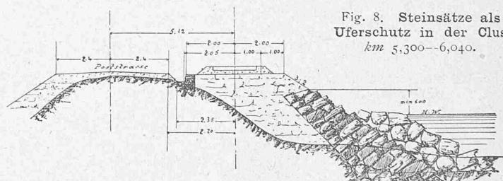
auf dieser Strecke im Winter in Trockenmauerwerk ausgeführt (Fig. 7 u. 8) und es beträgt deren Cubikmass 35000 m<sup>3</sup>. Der Grund, statt der Strasse die Bahn an den Fluss zu legen, wie es wohl in den meisten Fällen als technisch richtiger bezeichnet werden muss, liegt darin, dass diese Anordnung auf die ganze Länge die Verlegung einer Wasserleitung verursacht hätte und es gerechtfertigt erschien, den Bahnkörper so weit wie möglich von den Felswänden zu entfernen.
