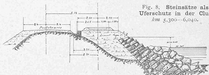
auf dieser Strecke im Winter in Trockenmauerwerk ausgeführt (Fig. 7 u. 8) und es beträgt deren Cubikmass  $35000\text{ m}^3$ . Der Grund, statt der Strasse die Bahn an den Fluss zu legen, wie es wohl in den meisten Fällen als technisch richtiger bezeichnet werden muss, liegt darin, dass diese Anordnung auf die ganze Länge die Verlegung einer Wasserleitung verursacht hätte und es gerechtfertigt erschien, den Bahnkörper so weit wie möglich von den Felswänden zu entfernen.
