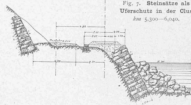
in die Clus. In diesem engen Felsenthor von etwa 1500 m Länge und begrenzenden Wänden von 600 m Höhe liegt die Bahn dicht am rechten Ufer der Landquart, indem hier der Bahnkörper theils dem Flusse in Form von Steinsätzen, theils der Strasse, durch Verschieben derselben und Anschneiden der Schuttkegel, abgewonnen werden musste.
