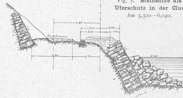
in die Clus. In diesem engen Felsenthor von etwa 1500 m Länge und begrenzenden Wänden von 600 m Höhe liegt die Bahn dicht am rechten Ufer der Landquart, indem hier der Bahnkörper theils dem Flusse in Form von Steinsätzen, theils der Strasse, durch Verschieben derselben und Anscheiden der Schuttkegel, abgewonnen werden musste.
