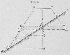
d. h. der Inhalt eines Querprofiles von der Axenböhe b mit geneigter Terrainlinie ist gleich demjenigen mit horizontaler Terrainlinie von der Höhe  $b+\frac{GH}{4}$ .\*)
