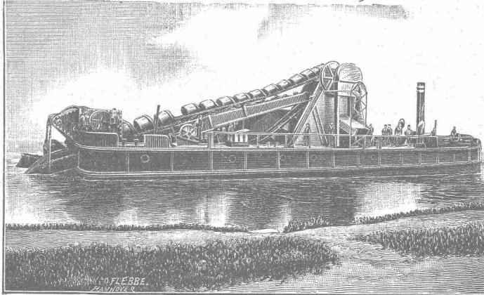
**Nass-Bagger** mit Leistung von 3000 Cubikmeter pro Tag.
