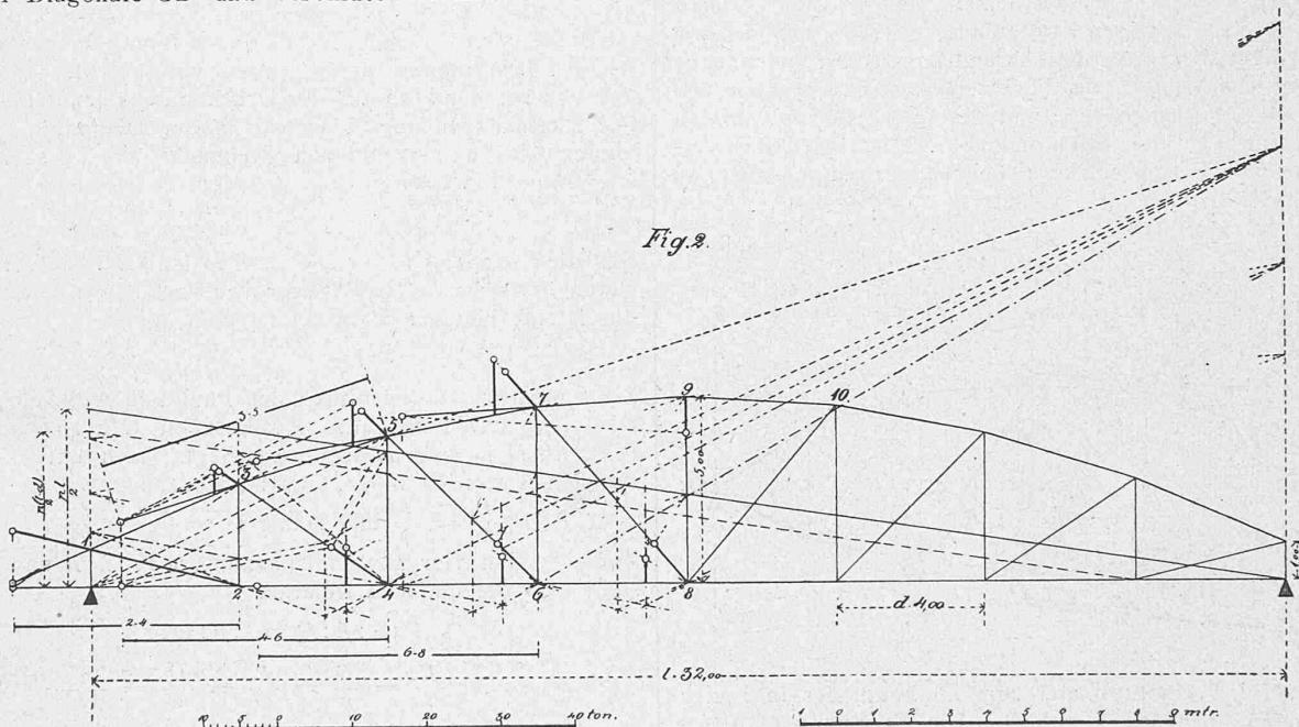
rechten Endpunkte von  $w'$ ; dann zieht man durch den linken Endpunkt von  $R'$  Parallele zu diesen Linien und verlängert sie bis zum Schnittpunkt mit  $CD$ . Die eine dieser beiden Parallelen schneidet auf der Diagonale die Kraft  $S'$  ab. Zieht man ferner durch den Schnittpunkt der zweiten Parallelen und von  $CD$  die Verticale, so ist das Stück derselben, welches zwischen dem Schnittpunkt und  $CH$  liegt, gleich der Kraft  $V'$ .
