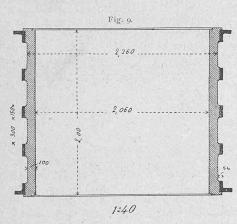
zuerst die Presscylinder aus 2 m hohen Zonen, der Fig. 9 entsprechend, mit 5 Ringen herzustellen. Die beiden äussern in Winkelform bilden gleichzeitig die Flanschen für die Längsverbindung der Cylinderstücke. Die drei Ringe in der Mitte sind 0,150 m hoch und 0,05 m dick.
