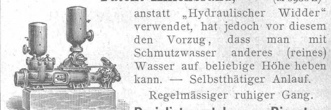
anstatt „Hydraulischer Widder“ verwendet, hat jedoch vor diesem den Vorzug, dass man mit Schmutzwasser anderes (reines) Wasser auf beliebige Höhe heben kann. — Selbstthätiger Anlauf.
