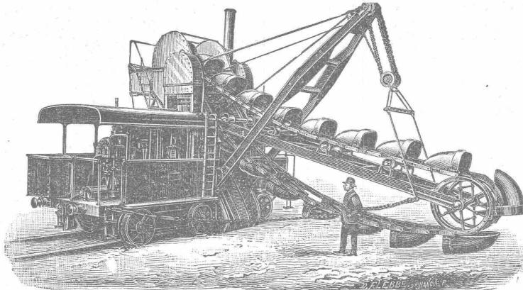
**Trocken-Bagger** mit Leistung von 3000 Cubikmeter pro Tag.
