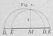
Fig. 1. Punkt  $M$  ist der Schwerpunkt. Zeichnet man über  $D_1 D_2$  einen Halbkreis und errichtet man in  $M$  ein Loth, so wird auf diesem der Halbmesser  $i$  der Ellipse abgeschnitten; klappt man diese Strecke nach links und rechts herunter, so bekommt man die Endpunkte  $E$  und  $E'$  der gesuchten Centralellipse.
