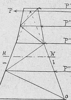
On sait que pour calculer les efforts agissant dans les trois pièces coupées par un plan MN, il suffit de déterminer la résultante P de toutes les forces extérieures agissant au-dessus de la section, et de décomposer cette résultante en trois forces passant par les pièces coupées.
