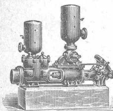
anstatt „Hydraulischer Widder“ verwendet, hat jedoch vor diesem den Vorzug, dass man mit Schmutzwasser anderes (reines) Wasser auf beliebige Höhe heben kann. — Selbstthätiger Anlauf.
